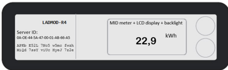
Abbildung 2: Zählerwert und öffentliche Schlüssel sind auf Messkapsel aufgedruckt
